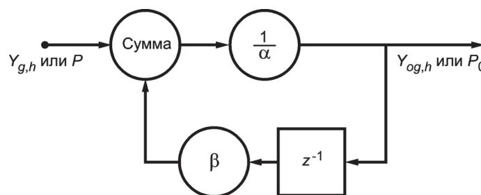
$z^{-1}$  — задержка, соответствующая длительности временного интервала измерения;  $\alpha, \beta$  — коэффициенты фильтра, приведенные в таблице 2
