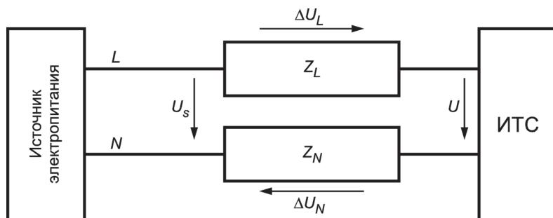
$U_s$  — напряжение «фаза — нейтраль» источника электропитания;  $U$  — напряжение на зажимах ИТС;  $Z_L$ ,  $Z_N$  — полные сопротивления проводов и входной цепи измерения тока;  $\Delta U$  — падение напряжения на сопротивлениях  $Z_L$ ,  $Z_N$  ( $\Delta U = \Delta U_L + \Delta U_N$ );  $L$  — фазный провод;  $N$  — нейтральный провод; ИТС — испытуемое техническое средство
