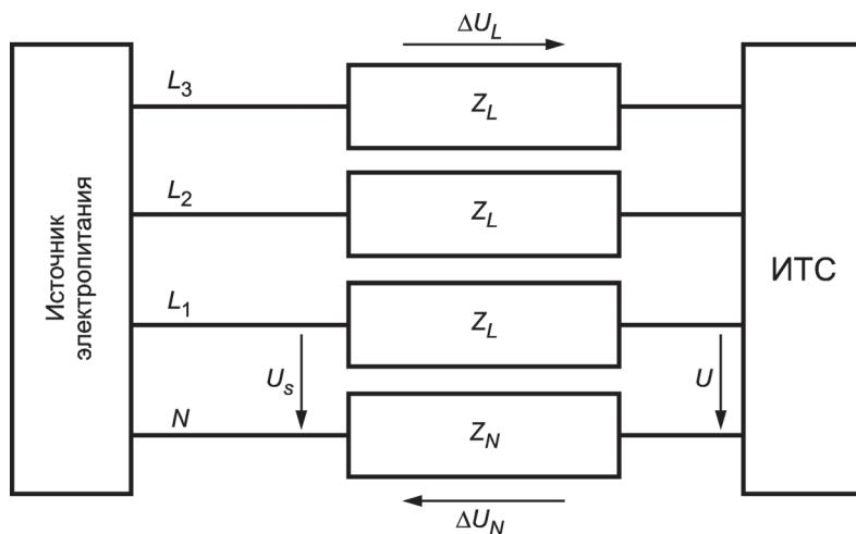
$U_s$  — напряжение «фаза — нейтраль» источника электропитания;  $U$  — напряжение на зажимах ИТС;  $Z_L$ ,  $Z_N$  — полные сопротивления проводов и входной цепи измерения тока;  $\Delta U$  — падение напряжения на сопротивлениях  $Z_L$ ,  $Z_N$  ( $\Delta U = \Delta U_L + \Delta U_N$ );  $L_1$ ,  $L_2$ ,  $L_3$  — фазные провода;  $N$  — нейтральный провод; ИТС — испытуемое техническое средство
